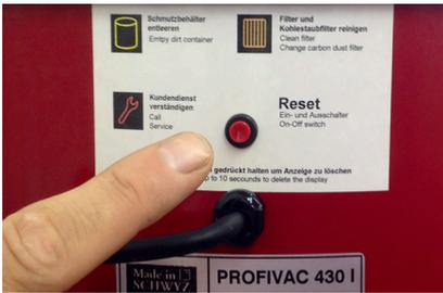
Starten Sie die Zentrale Staubsauger-Anlage mit der Taste am Gerät.
