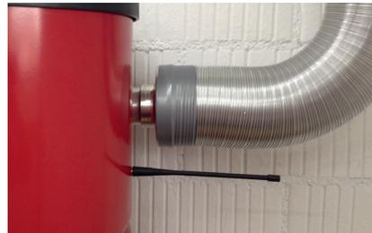
Die im Schmutz-Tank liegende Stab-Antenne für WIRELESS Benutzung rechts am Gerät aufschrauben.
