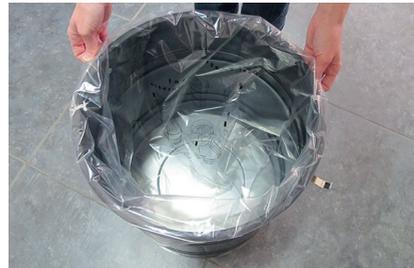
5. Legen Sie einen neuen Staubsack in den Schmutzbehälter. Ziehen Sie den Verschluss des Staubsackes so weit über den Rand des Schmutzbehälters, bis der Staubsack aussen 2 Zentimeter überhängt. Die Zugbänder sollen genau nach vorne zeigen. Ziehen Sie vorsichtig an den Bändern, bis der Aussenrand des Staubsackes eng am Schmutzbehälter anliegt.
