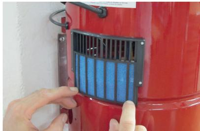
1. Schieben Sie das Kohlenstaubfilter-Gitter nach unten.
