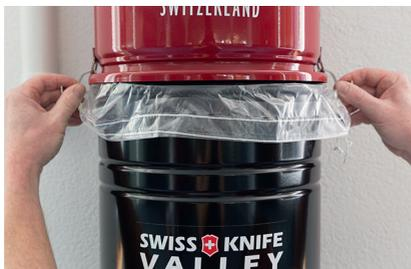
1. Le bac à poussière est maintenu par deux fermetures à genouillère. Ouvrez ces fermetures en les poussant vers le haut. Le bac à poussière est maintenant suspendu dans les fermetures.
