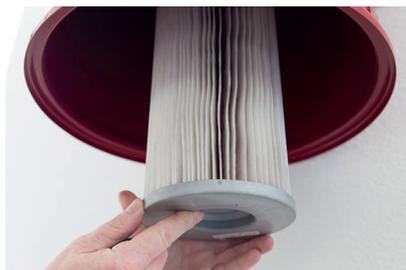
5. Une fois complètement séché à l'air, réinsérez le filtre. Poussez le filtre par dessus son support et serrez fermement les vis.
