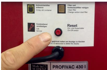
Avviare il sistema di aspirazione centralizzata premendo l'apposito tasto sull'apparecchio.
