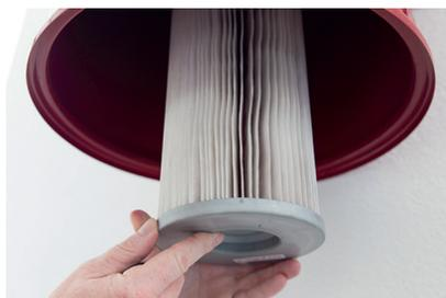
5. Dopo che si è completamente asciugato, rimontare il filtro. Spingere il filtro nell'apposito supporto e riavvitare saldamente la vite.
