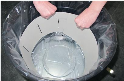
6. Ogni sacchetto per la polvere è dotato di cartone. Inserire il cartone nel sacchetto per la polvere come mostrato in figura. Prestare attenzione affinché il sacchetto per la polvere aderisca alle pareti del contenitore per lo sporco.
