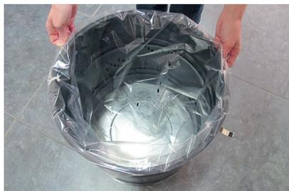
5. Inserire un nuovo sacchetto per la polvere nel contenitore per lo sporco. Tirare la chiusura del sacchetto per la polvere attorno al bordo del contenitore per lo sporco in modo che il sacchetto per la polvere sporga di 2 cm. Le corde devono essere rivolte in avanti. Tirare con attenzione le corde fino a che il bordo esterno del sacchetto per la polvere non aderisce al contenitore per lo sporco.
